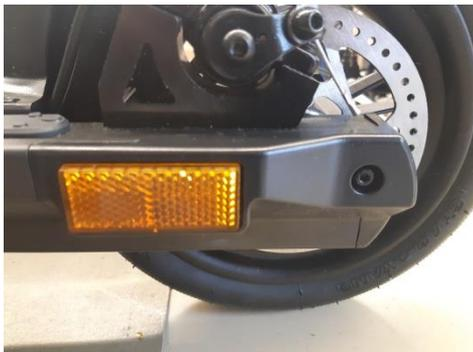
Retirer les vis allen (taille 2,5) des capots de protection de la fourche.
