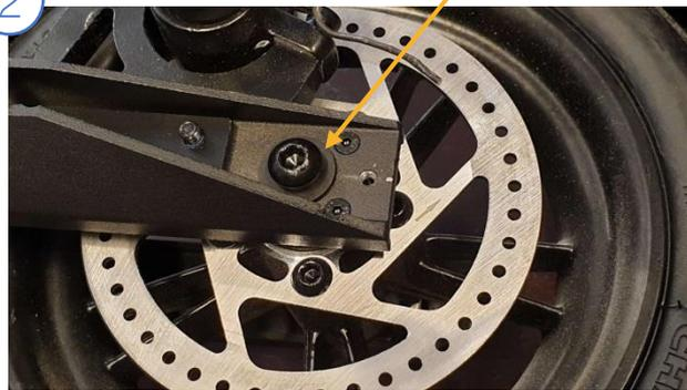
Reserrer les vis allen (taille 5) de part et d'autre de la fourche qui maintiennent la roue arrière. Aidez-vous de frein-filet afin d'éviter le desserrage de la roue.
