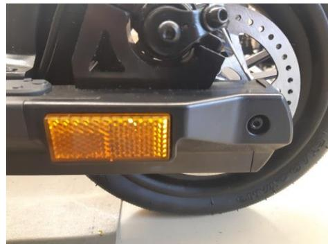
Remettre les vis allen (taille 2,5) des capots de la fourche.
